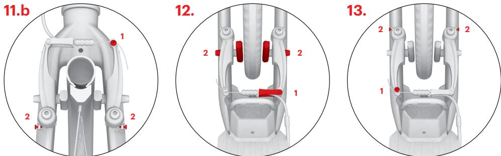
Zkontrolujte, zda se špalíky při uvolnění brzdové páčky dostatečně oddálí od ráfku (1-2 mm). Vzdálenost špalíků lze upravit přítažením či povolením brzdového lanka v kotevním šroubu (1). Pokud kolo při otáčení v některém místě škrťá o brzdový špalík, symetricky upravte vzdálenost brzdových rámů napínacími šroubkami (2).
