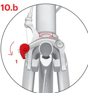
Если колесо при вращении задевает тормозную колодку, поверните слегка весь тормозной механизм так, чтобы плечи тормоза были на одинаковом расстоянии от обода. Положение плеч зафиксируйте, повернув рычажок вниз (1).
