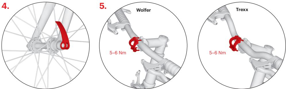
Затяните настроечную гайку эксцентрика так, чтобы перед закрытием рычажка эксцентрика вы почувствовали значительное сопротивление. Рычажок закройте в таком положении, чтобы он не прикасался к вилке, и в то же время чтобы исключить его случайное открытие во время езды.
