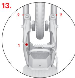
Überprüfen Sie, dass der Abstand der Bremsbeläge von der Felge bei unbetätigtem Bremshebel etwa 1-2 mm beträgt. Dieser Abstand lässt sich durch das Anziehen oder Lockern des Bremsseils in der Fixierschraube (1) regulieren. Falls der Reifen beim Drehen an irgendeiner Stelle den Bremsbelag streift, stellen Sie die Entfernung der Bremsarme durch die Spannschrauben (2) symmetrisch ein.
