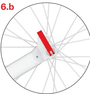
Die hintere Gabel mit zwei Positionen ermöglicht die Einstellung der Trittbreithöhe. Die untere Gabelhalterung ist für Geländefahrten bestimmt. Schließen Sie den Schnellspannhebel so, dass er nach oben zeigt.
