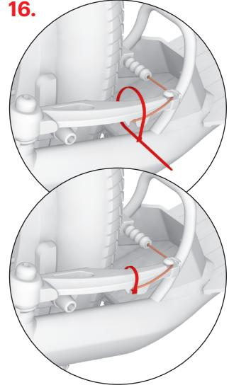
Закрепите конец троса тормоза в замке и закрепите его затяжным хомутом, затем отрежьте лишний конец.
