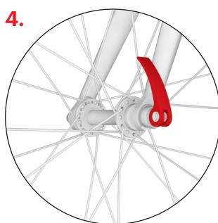
Dotáhněte seřizovací matici rychloupínáku, těsně před dovršením rychloupínací páčky byste měli cítit značný odpor. Páčku zavřete v takové pozici, aby se nedotýkala vidlice a zároveň nemohlo dojít k jejímu náhodnému otevření během jízdy.
