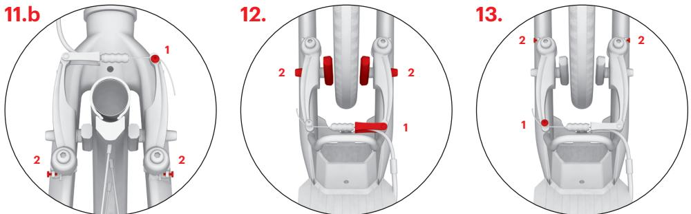
Проверьте, чтобы при отпускании ручки тормоза колодки достаточно отдалились от обода (1–2 мм). Расстояние между колодками и ободом можно настроить, прижав или ослабив тормозной трос в крепёжном болте (1). Если колесо при вращении в каком-либо месте трётся о тормозную колодку, измените симметрично расстояние до рычагов тормоза с помощью натяжных болтиков (2).
