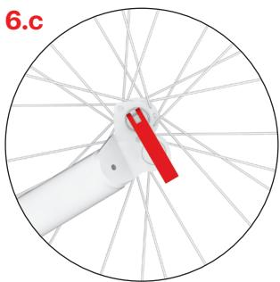
Die obere Gabelhalterung, verringert die Höhe des Trittbretts und entlastet zugleich das Standbein, ist für Fahrten auf ebener Oberfläche bestimmt. Die Fahrt ist somit weniger anstrengend. Schließen Sie den Schnellspannhebel so, dass er nach unten zeigt.
