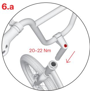
Představec zasuňte do trubky rámu koloběžky a nastavte požadovanou výšku říditek, max. však po vyznačenou rysku, viz obr. 6.b. Zkontrolujte, zda jsou řídítka rovně (kolmo k ose kola) a dotáhněte šroub na představci.
