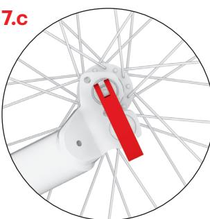
Верхняя скоба вилки, которая снизит высоту деки и в то же время разгрузит опорную ногу, предназначена для езды по гладкой и ровной поверхности. Езда будет физически легче. Рычаг эксцентрика закройте так, чтобы он был направлен вниз.
