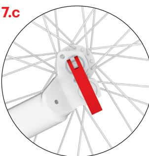
Die obere Gabelhalterung, verringert die Höhe des Trittbretts und entlastet zugleich das Standbein, ist für Fahrten auf ebener Oberfläche bestimmt. Die Fahrt ist somit weniger anstrengend. Schließen Sie den Schnellspannhebel so, dass er nach unten zeigt.
