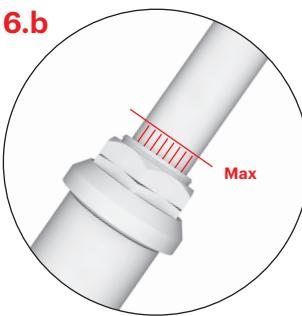
Die höchstmögliche Höhe des Lenkers ist mit Strichen gekennzeichnet, diese sollten bei der höchstmöglichen Einstellung nur zum Teil sichtbar sein.
