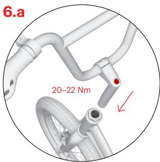
Schieben Sie die Lenkerstange in das Hauptrohr des Tretrollerrahmens und stellen Sie die gewünschte Höhe des Lenkers ein (bis max. in Höhe des gekennzeichneten Striches, siehe Abb. 6.b). Überprüfen Sie, ob der Lenker gerade ist und ziehen Sie die Schraube der Lenkerstange fest.
