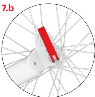
Двухпозиционная задняя вилка позволяет приспособить высоту деки. Нижнюю скобу используйте для езды по бездорожью. Эксцентрик закройте так, чтобы его рычажок был направлен наверх.
