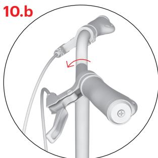
Správny sklon brzdových páčok nastavíte tak, že si stúpnete na stúpadlo, uchopite riadiidlá a natiahnete prsty tak, aby predzíli priamku ruky. V tejto polohe nastavte páčky a u oboch dotiahnite upevňovacie skrutku, pozri 10.a.
