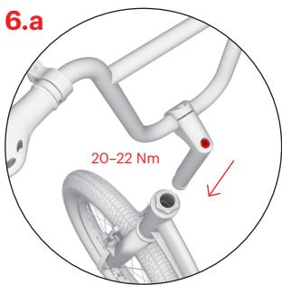
Predstavec zasuňte do rúrky rámu kolobežky a nastavte požadovanú výšku riadičiel, max. však po vyznačeném rysku, pozri obr. 6.b. Skontrolujte, či riadičia sú rovno a dotiahnite skrutku na predstavci.
