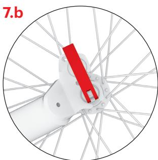
Die hintere Gabel mit zwei Positionen ermöglicht die Einstellung der Trittbreithöhe. Die untere Gabelhalterung ist für Geländefahrten bestimmt. Schließen Sie den Schnellspannhebel so, dass er nach oben zeigt.
