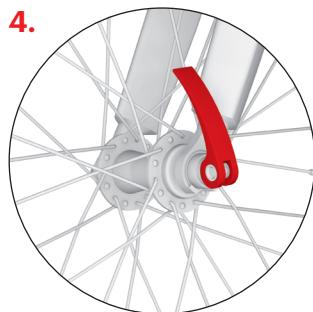
Drehen Sie die Schraubenmutter nur so nach, dass Sie vor dem Schließen des Schnellspannhebels einen Widerstand fühlen. Schließen Sie den Hebel so, dass er die Gabel nicht berührt und sich während der Fahrt nicht öffnen kann.
