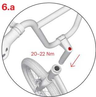
Рулевую колонку вставьте в трубу рамы самоката и установите желаемую высоту рукяток, но не выше ограничительной риски (см. рис.6б). Убедитесь, что рукятки размещены правильно (перпендикулярно плоскости колеса) и затяните болт на выноске.
