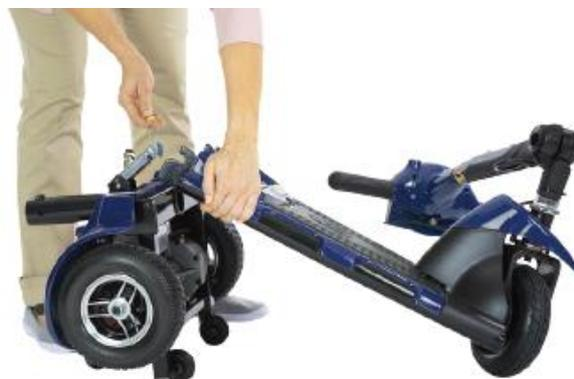
7. Zvedněte část, kde jsou dvě části spojené a uvolněte je z háčků.
