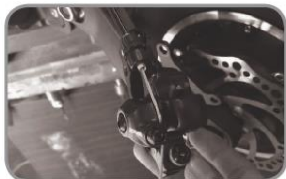
2. Brzdový třem se oddělí
