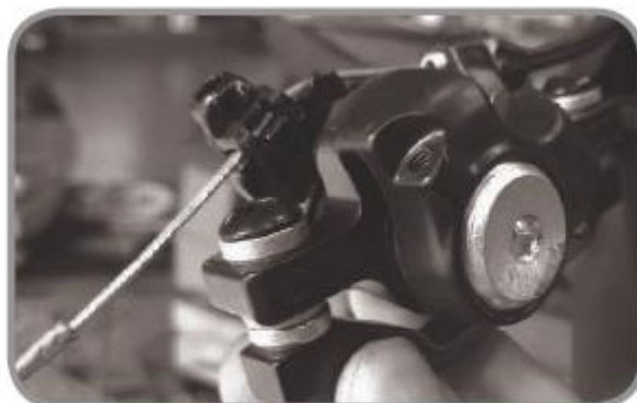
3. Šroub na obrázku drží destičky, po výměně je musíte opět dotáhnout
